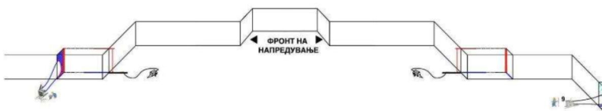
Слика 30: Централен "U" канал
