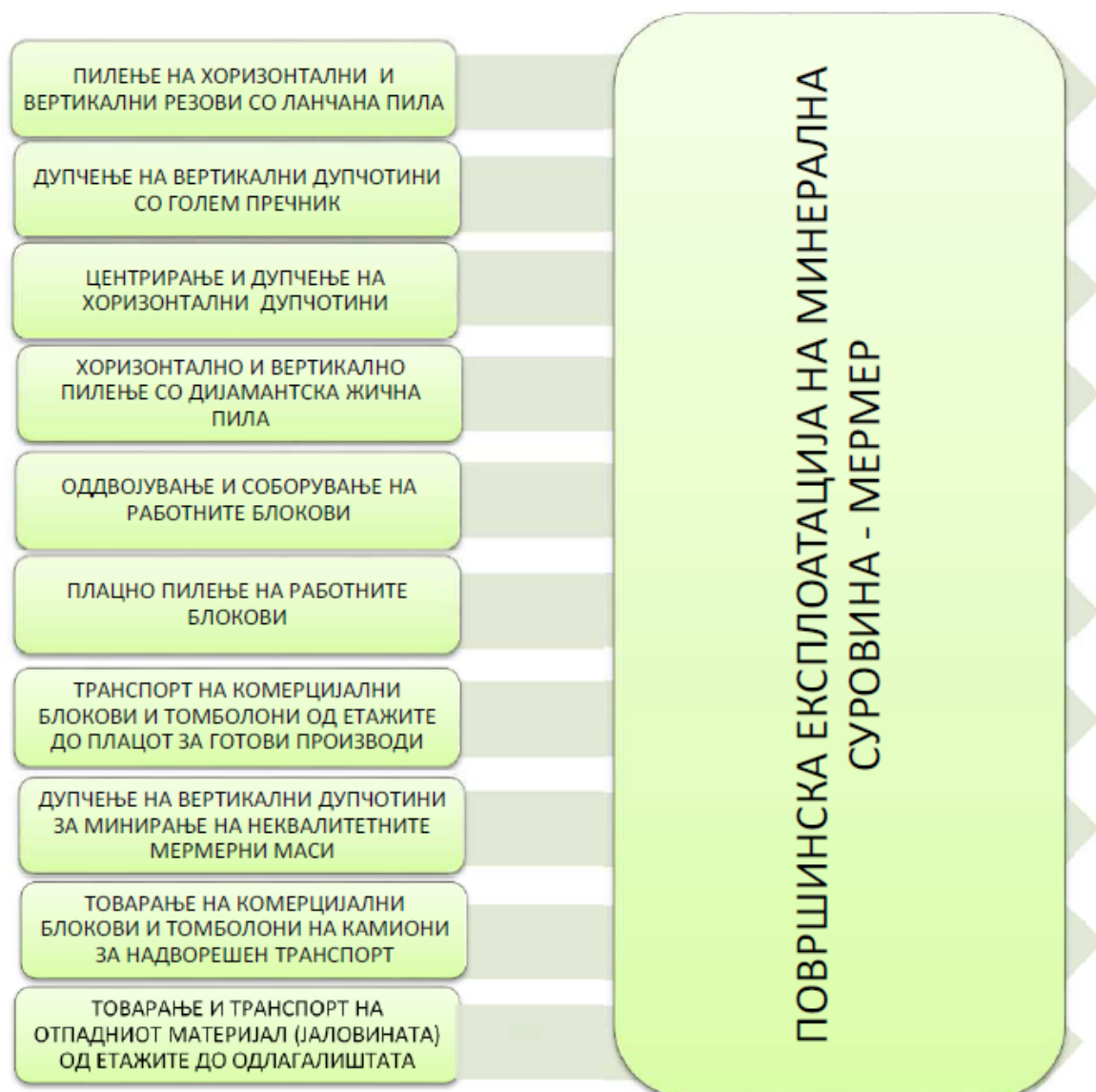
Слика 2 Технолошка шема на експлоатација на мермерни блокови
