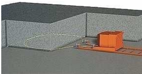
Слика 2.12.5 Пилење на хоризонтален рез
