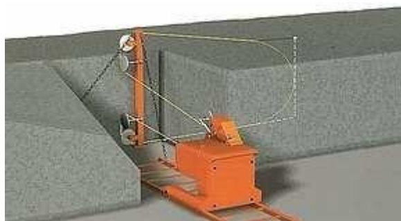
Слика 2.12.6 Пилење на вертикален рез одгоре надолу со помош на водечки тркала
