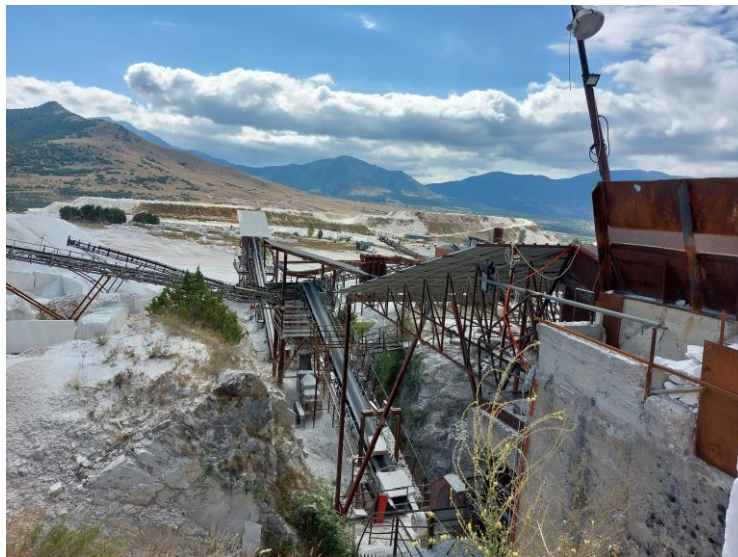
Слика 100: Дробилична постројка
