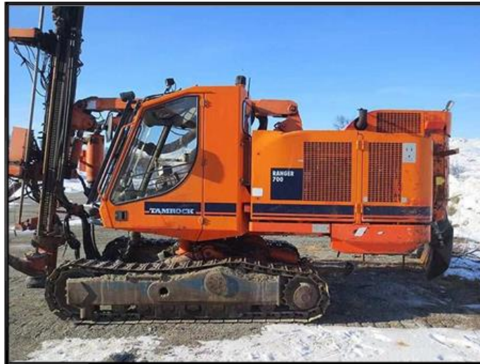
Слика 26: Самоодна дупчалка “TAMROCK RANGER 700”
