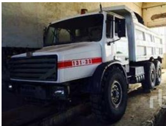
Слика 75: Камион “PERLINI 131.30” за внатрешен транспорт на блокови и томблони
