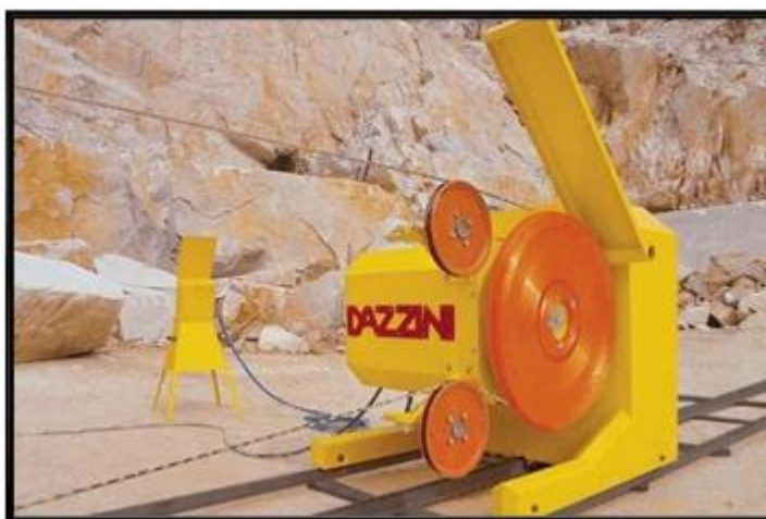
Слика 52: Дијамантска жична пила "DAZZINI S860E"
