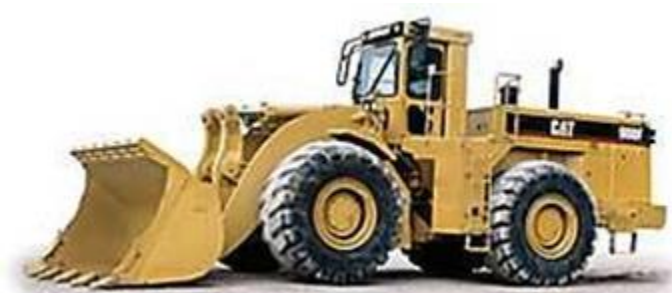
Слика 77: Товарна машина "CAT 988F"
