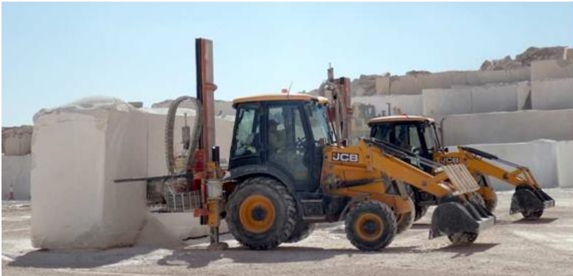
Слика 73: Плацно сечење со “FANTINI TERNA”
