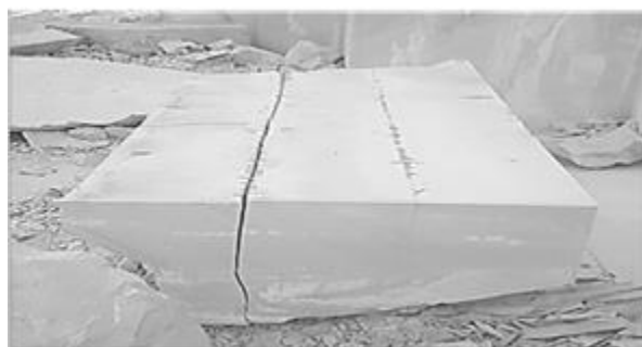
Слика 72: Цепење на работен блок со експандирачка смеса
