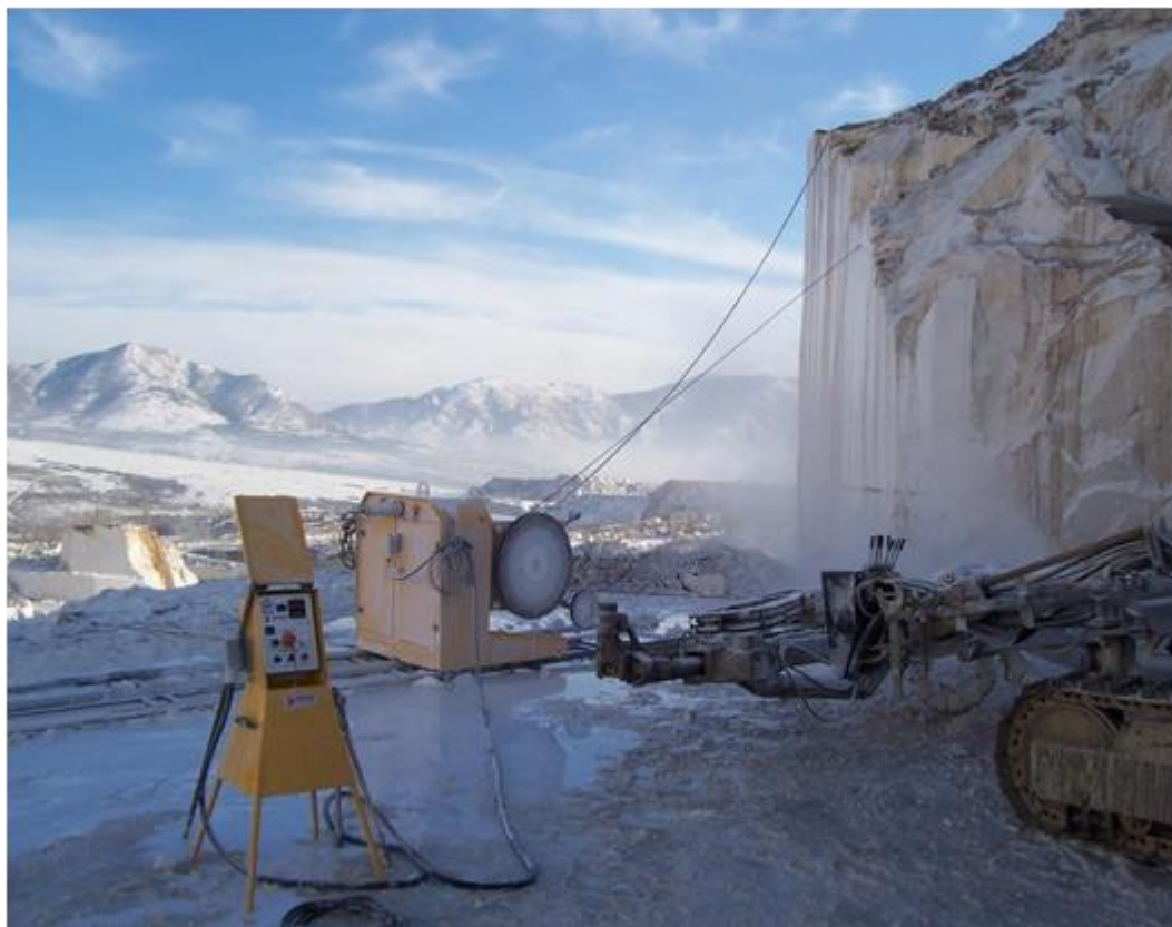
Слика бр.31 Вертикалното сечење со дијамантска жична пила
