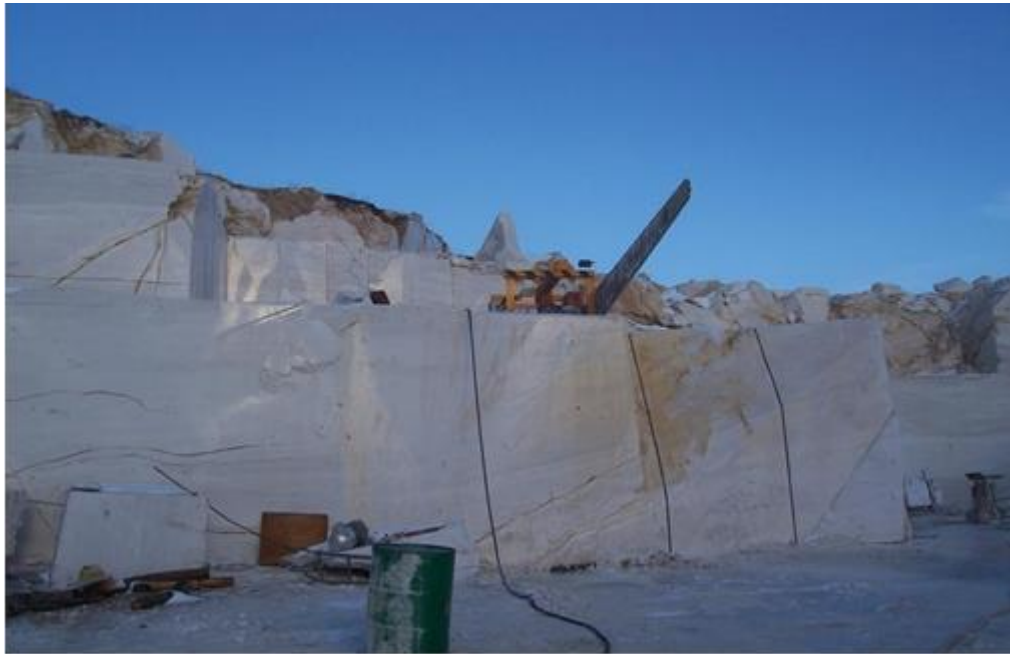
Слика бр.25 Каменорезна машина за вертикално сечење
