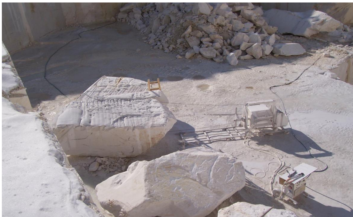
Сликата бр.33 Кроење со дијамантска жична пила
