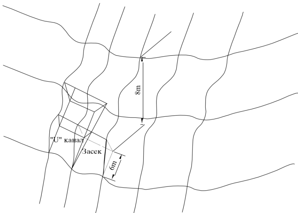
Слика бр.9 Изработка на "U" каналот
