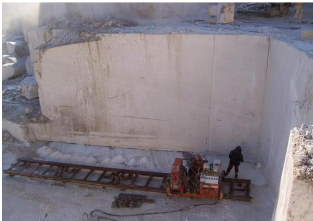
Слика бр.27 Каменорезна машина FANTINI 70 RA/P при хоризонтално сечење
