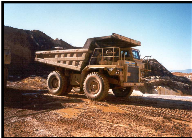
Слика 20: Руднички дампер CATERPILLAR 769C
