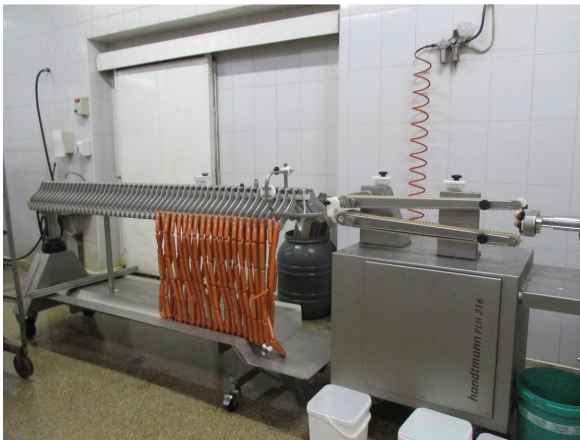
Слика 12 Линија Handtmann PLH 216 за вртење и прикачување за рамно полнење на вештачки и природни црева
