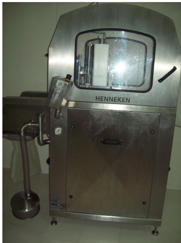
Слика 7 Ињектор HENNEKEN за вбризување солен раствор во месо
