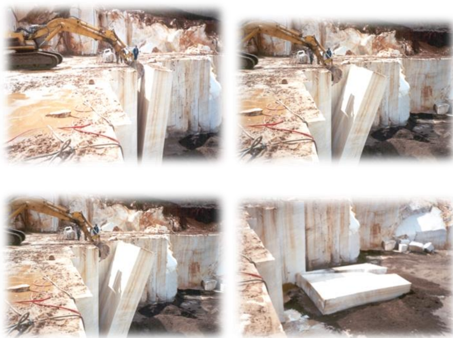
Слика 2.13.5. Соборување на работен блок со багер
